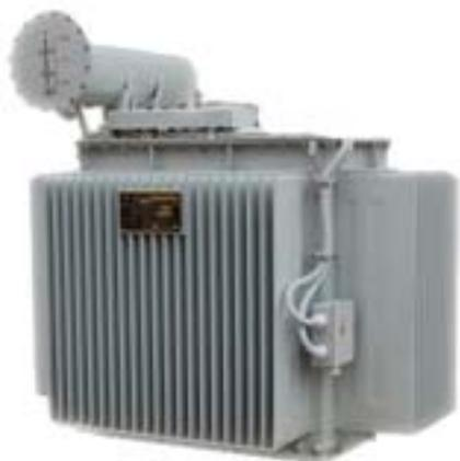
**Реакторы серии РУОМ** управляемые дугогасящие однофазные с масляным охлаждением типа РУОМ используются в электрических сетях 6 или 10 кВ с изолированной нейтралью в качестве заземляющего дугогасящего устройства с автоматической компенсацией емкостного тока замыкания на землю и предназначены для автоматической компенсации ёмкостных токов замыкания на землю; предотвращения переходов однофазных замыканий на землю в короткие замыкания электрической сети.
